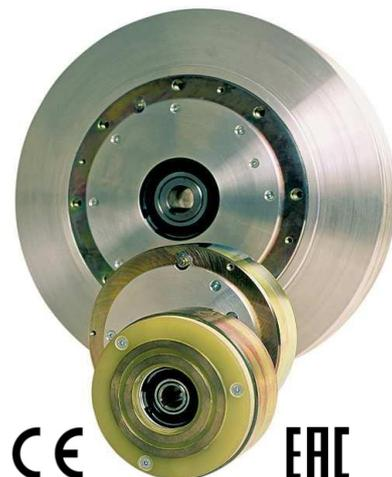
Порошковые тормоза и муфты обеспечивают построение электроприводов, в которых крутящий (тормозной) момент может плавно регулироваться (программироваться), в соответствии с потребностями пользователя, в диапазоне от остаточного значения  $M_r$  ( $M_r \leq 1\% M_n$ ), до номинального  $M_n$  (см. в таблице).
