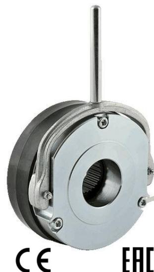
Электромагнитные дисковые тормоза постоянного тока с пружинным включением, электромагнитным отпуском, серии H2SP, предназначены для торможения вращающихся частей приводов и их точного позиционирования. Тормоза характеризуются простотой конструкции, обеспечивающей высокую повторяемость, даже при большом числе включений. Дополнительным достоинством является стабильная работа – что является особенно важным, если устройство имеет несколько приводов. Конструкция тормоза гарантирует простой монтаж.
