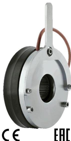
Электромагнитные дисковые тормоза постоянного тока с пружинным включением, электромагнитным отпуском, серии H2S, предназначены для торможения вращающихся частей приводов и их точного позиционирования. Тормоза характеризуются простотой конструкции, обеспечивающей высокую повторяемость, даже при большом числе включений. Дополнительным достоинством является стабильная работа – что является особенно важным, если устройство имеет несколько приводов. Конструкция тормоза гарантирует простой монтаж.
