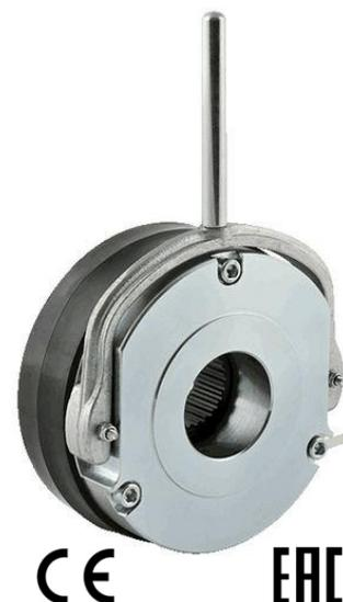
Электромагнитные дисковые тормоза постоянного тока с пружинным включением, электромагнитным отпуском, серии H2SPX, предназначены для торможения вращающихся частей приводов и их точного позиционирования. Тормоза характеризуются простотой конструкции, обеспечивающей высокую повторяемость, даже при большом числе включений. Дополнительным достоинством является стабильная работа – что является особенно важным, если устройство имеет несколько приводов. Конструкция тормоза гарантирует простой монтаж.
