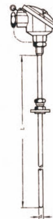
固定卡套法兰、 可动卡套法兰 Fixed ferrule flange, movable ferrule flange
