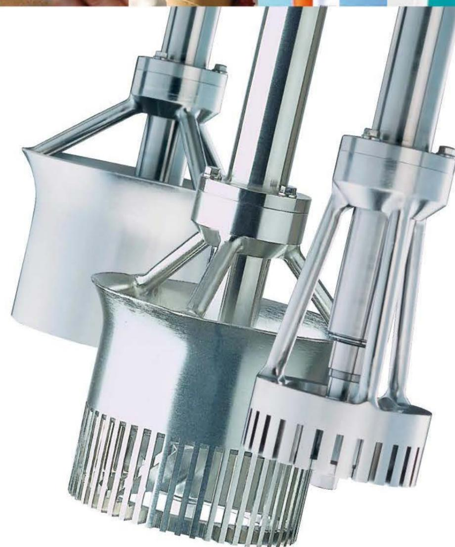
Высокоскоростное диспергирующее оборудование *ystral* работает на основе роторно-статорного принципа, используя высокую окружную скорость. Равномерное распределение одинакового размера твердых частиц (суспензии) и жидкостей (эмульсии) в основной жидкости достигается благодаря взаимодействию различных стадий уменьшения размеров частиц. Диспергирующий инструмент индивидуально адаптируется под соответствующий технологический процесс.
