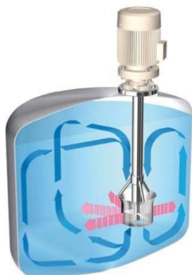
Вторая часть жидкости направляется по горизонтали и проходит через зону диспергирования DISPERMIX.
